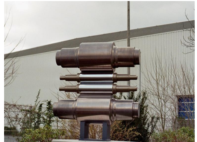
Beispiel Arbeits- und Stützwalzen.
