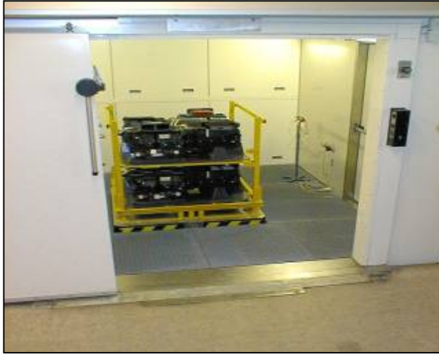
Klimakammer mit Schwingprüfanlage
