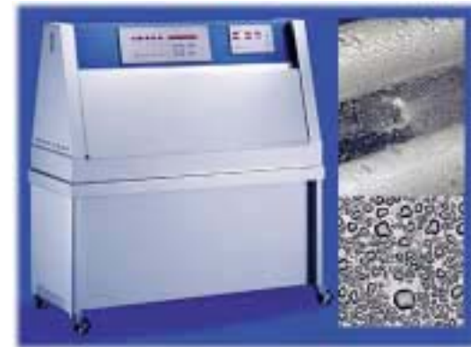
Testanlage für UV- und Bewitterungstests
