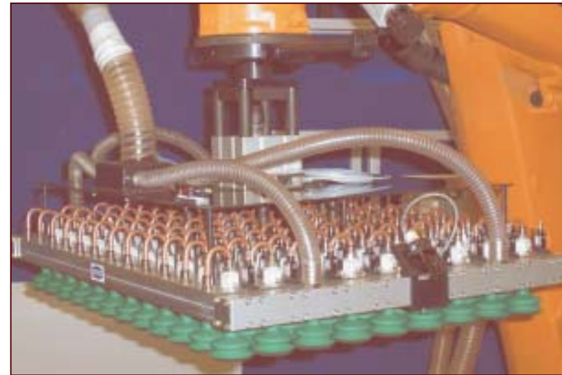
Lösung 2: Matrix-Greifer für ebene Lagen (z.B. in Lebensmittel-Verteilzentren)
