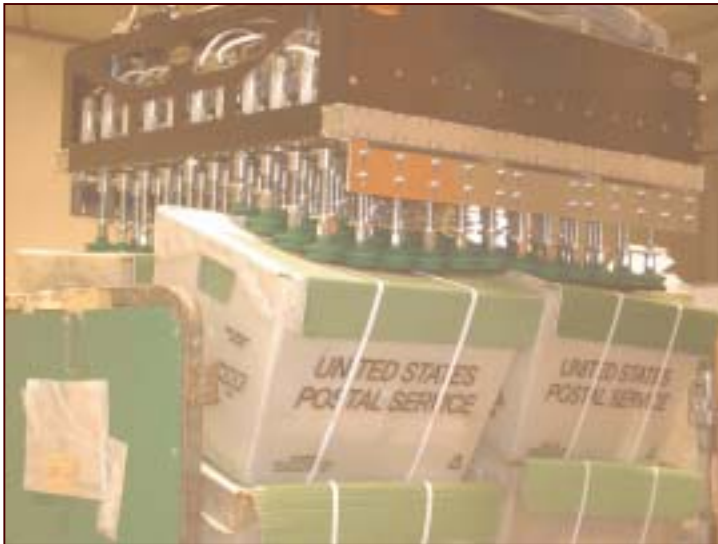
Lösung 1: Matrix-Greifer für unebene Lagen
