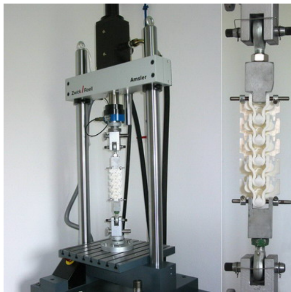
Abb. 1: Dynamische Prüfmaschine und Einspannvorrichtung für Kettenmuster
