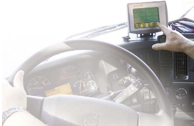
Abb. 4: Einbaubeispiel Bordrechner [Foto Max Bögl]
