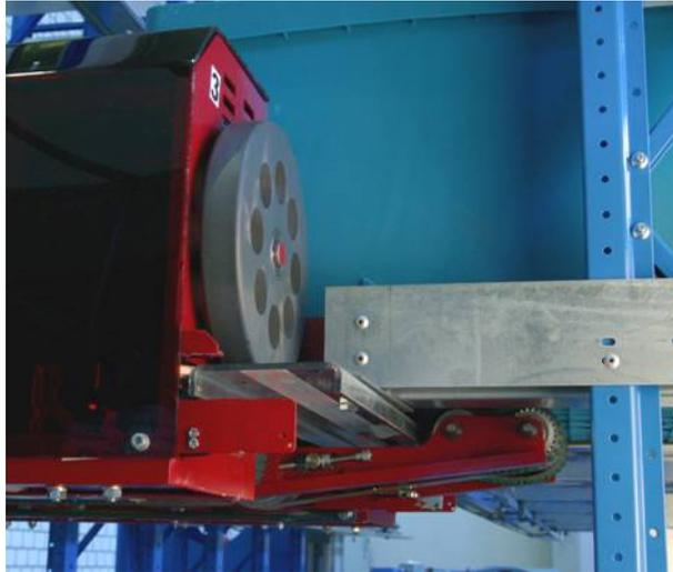
Abb. 3: Lastaufnahmemittel am System MultiShuttle
