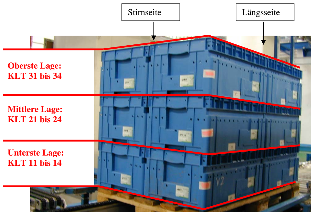
Abb. 9: Lagenstapelung der KLT auf Palette und Nummerierung der KLT
