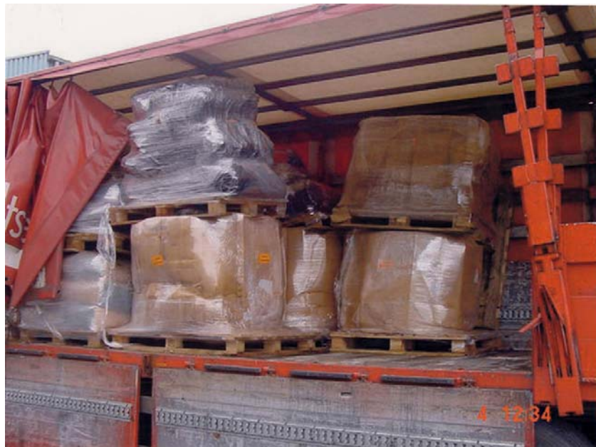
Abbildung 1: Beispiel für mangelhafte Ladungssicherung, Ladeeinheitensicherung und Verpackungsauslegung (Bildquelle: StAfA)
