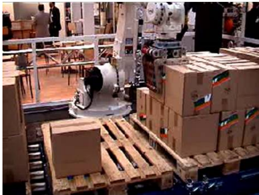
Abb. 31: Einsatz des Greifers beim Depalettieren, Hannover Messe 2005
