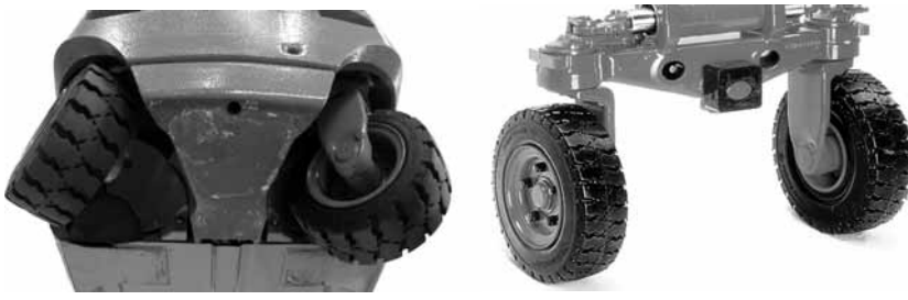
Abb. 5: Optimierte Gestaltung von Heckgewicht und Hinterachse
