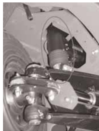
Abb. 7: System zur Arretierung der Pendelachse mittels Hydraulikzylinder. links: Prinziskizze, rechts: Foto der praktischen Ausführung
