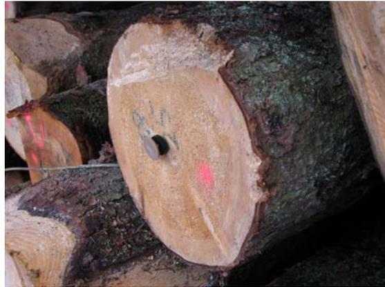
**Abb. 1:** Beispiel eines von der Forstlichen Versuchs- und Forschungsanstalt Baden-Württemberg und dem Ingenieurbüro Dr. Föllner & Partner zusammen entwickelten recyclefähigen Rundholz-Kennzeichnungssystems bestehend aus einem Ring-Transponder und dazugehörigem Nagel aus biologisch abbaubaren Material, der im Sägewerk abgeschert wird
