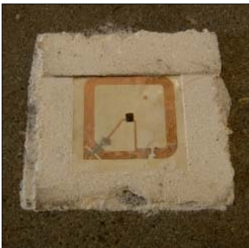
Abbildung 8: Eingehauster Transponder (freigeschnitten)
